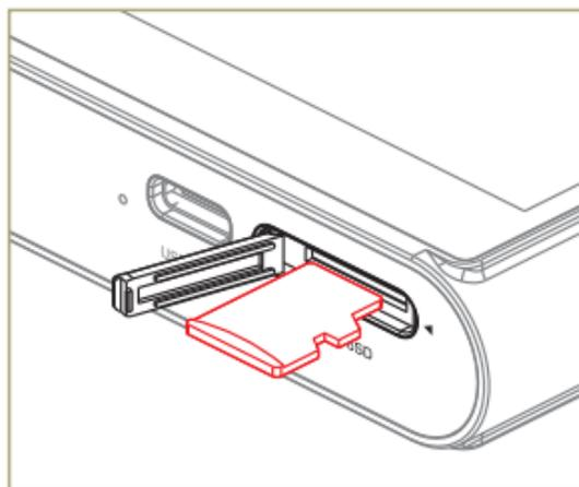
2. Micro SDカードを図の方向に抜き差しし、カードカバーを閉じる。
